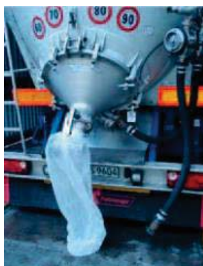
使用塑膠袋套在 產品排放孔
