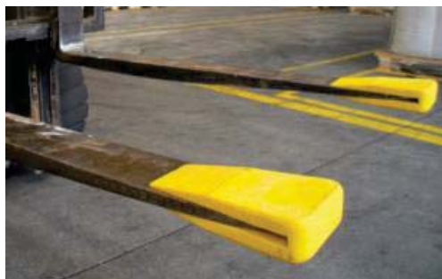
堆高機的枒杈以泡棉包覆，避免傷到太空包尖端
